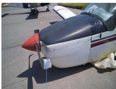
Déformation au niveau des pales de l'hélice
