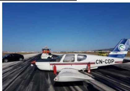
Position de l'Épave sur la piste après glissade
