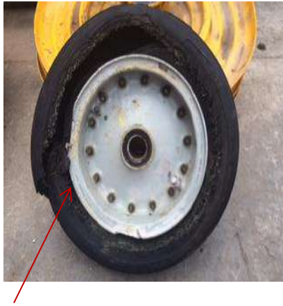
Dégâts enregistrés sur la jante gauche
